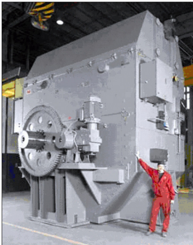
Рисунок 3.26: Привод компрессора с номинальной мощностью 24 МВт
