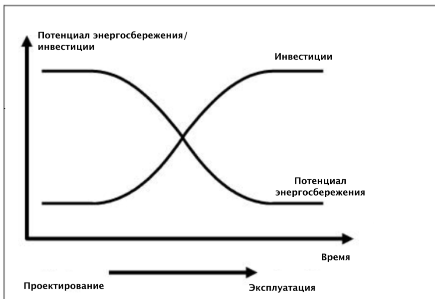
Рисунок 2.4: Потенциал энергосбережения и соответствующий объем инвестиций на этапах проектирования и эксплуатации
