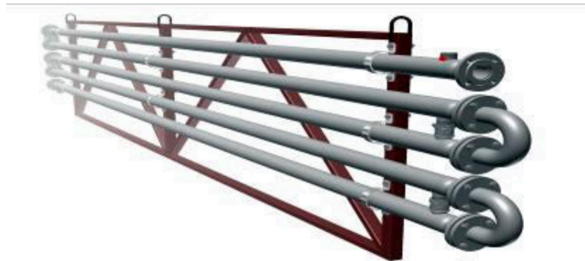
Рисунок 6-28. Общий вид утилизатора на несущей раме
