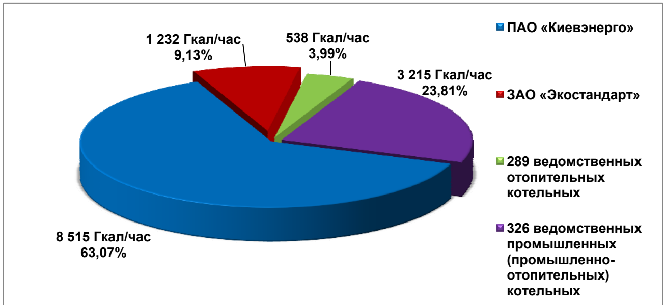
Рисунок 2.1.2. Баланс установленной мощности предприятий теплоснабжения
