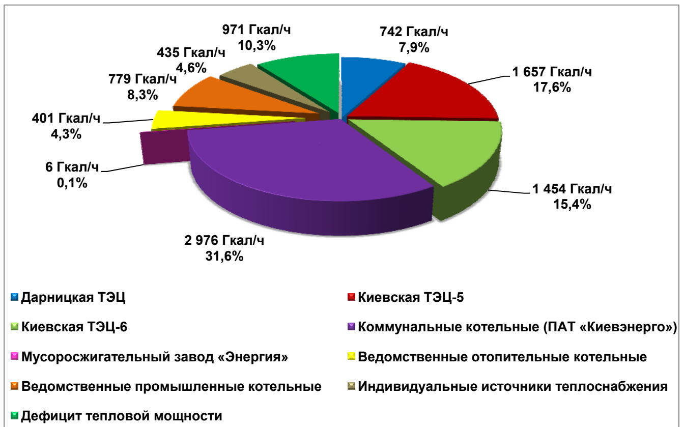
Рисунок 2.1.3. Баланс тепловой нагрузки основных укрупненных источников тепловой энергии
