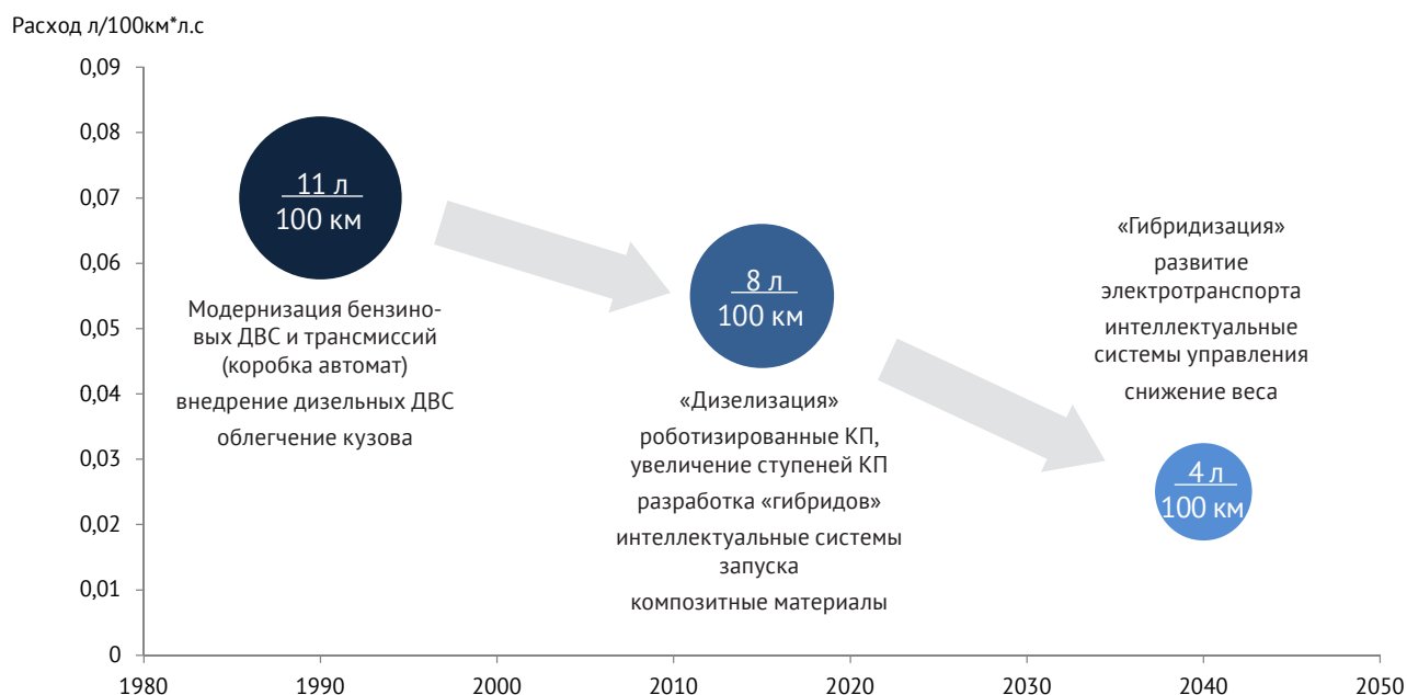
Рисунок 2.2. – Динамика экономии топлива на легковых автомобилях
