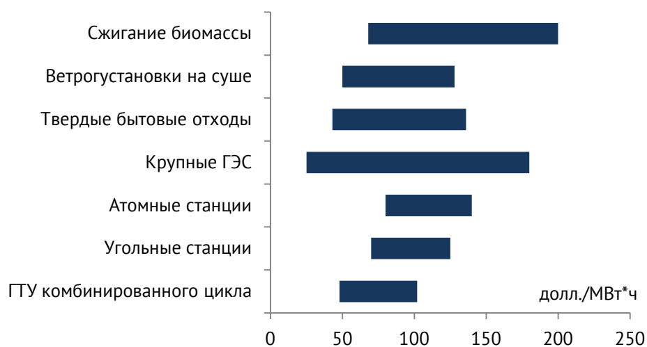
Рисунок 2.41. – Удельные дисконтированные затраты производства электроэнергии по видам энергоресурсов, 2012 г.
