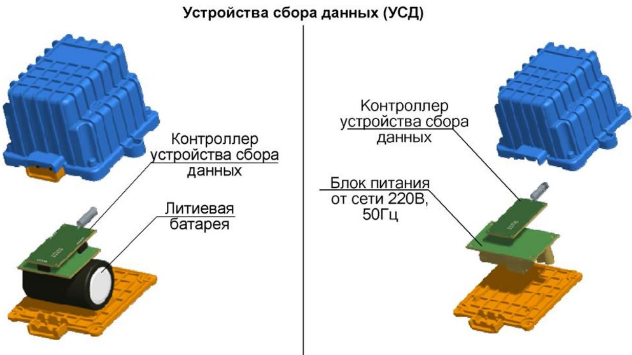
Устройства сбора данных имеют двунаправленный радиоканал обмена информацией, что позволяет синхронизировать время всех устройств, подключать внешние исполнительные устройства например, для отключения электроснабжения у должников.
