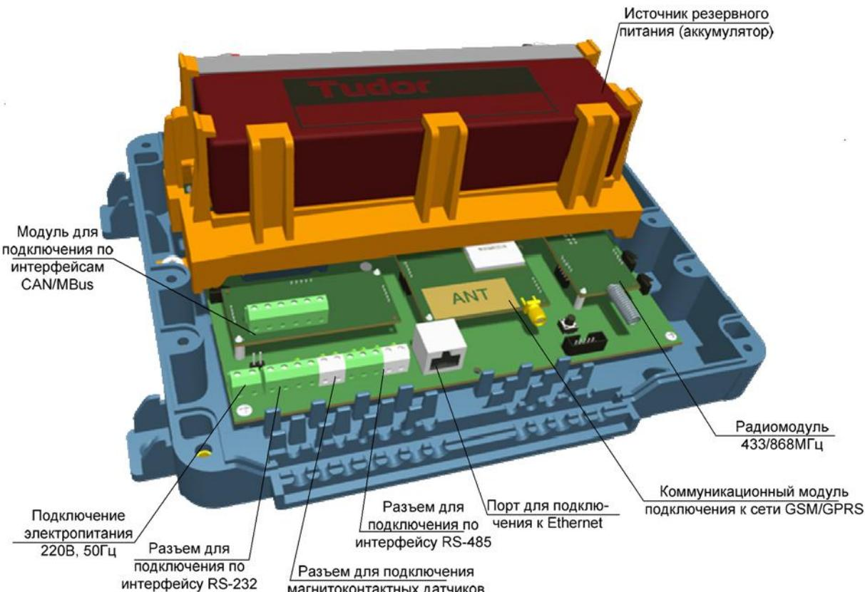
Выходные интерфейсы устройства (для передачи на сервер коммерческого учета) включают:
