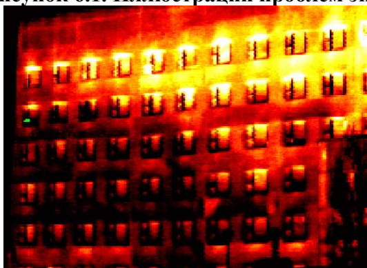
Тепловизионное изображение фасада больницы в г. Троицк Московской области. В здании верхняя центральная разводка. На верхних этажах «перетоп» и открыты форточки, а на угловых нижних – «недотоп» и используются электрообогреватели
